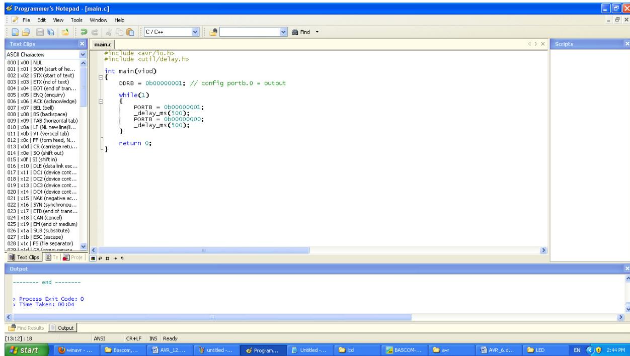
برای کامپایل برنامه از منوی Tools بر روی Make All و یا Make Clean کلیک کنید. پس از انجام عملیات در صورتی که مرتکب خطایی نشده باشد در قسمت پایین پنجره عبارت Process Exit Code: 0 نمایش داده می شود. در این حالت اگر به پوشه LED مراجعه کنیم فایل Hex را مشاهده خواهیم کرد و می توانیم آن را در میکرو بارگزاری نماییم.
