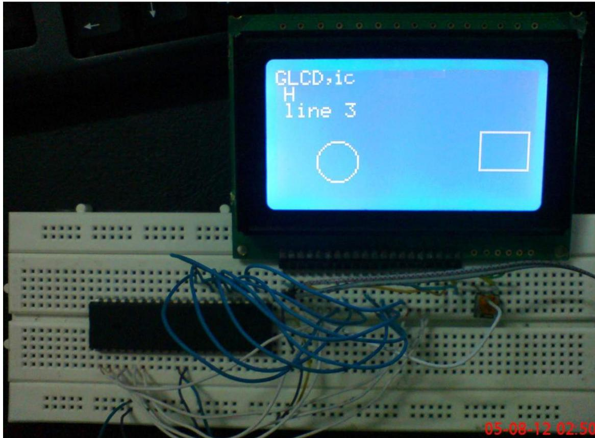
تابع `glcd.h` شامل توابع کاربردی بسیار زیادی برای کار با انواع LCD های گرافیکی می باشد. در این پروژه این تابع به همراه درایور `KS0108` استفاده شده است. در واقع `KS0108.h` در سطح سخت افزار عمل کرده و `glch.h` در لایه بالاتر و `rprintf.h` در لایه کاربر فعالیت می کند. کاربری که با دستورات `rprintf` کار می کند انتظار دارد که متن هایش در نمایشگر نشان داده شود. در این پروژه همچنین می توان به طور مستقیم از توابع `glcd.h` نیز استفاده کرد. توابعی مثل تابع رسم دایره و چهار ضلعی از این دسته اند.
